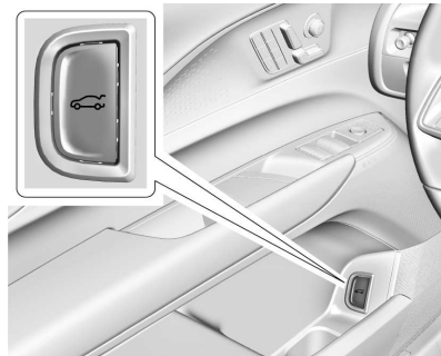
Inside Door Switch
