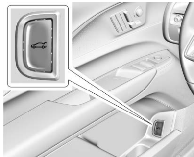
Inside Door Switch
